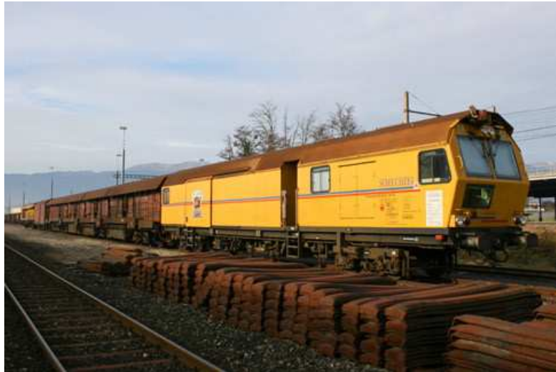
Train meuleur de rails (Scheuchzer S.A.)
