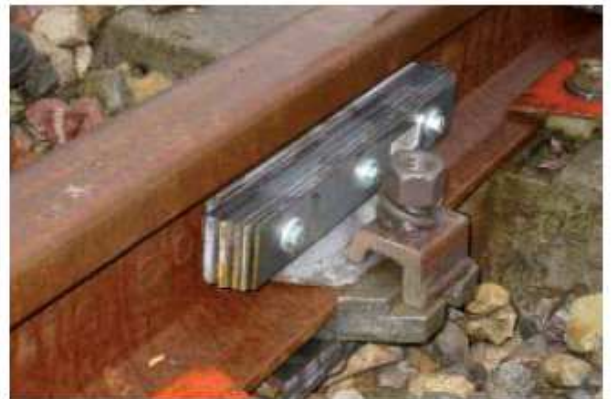
Exemples d'absorbeurs dynamiques sur rail (Corus et Socitec)
